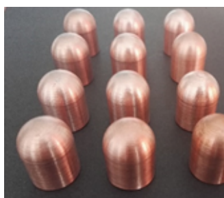
Rys. 1. Widok elektrod odkutych z materiału ze wzbogaconą laserowo warstwą wierzchnią
