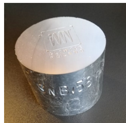
Rys.1. Stop cyny i bizmutu SnBi58
